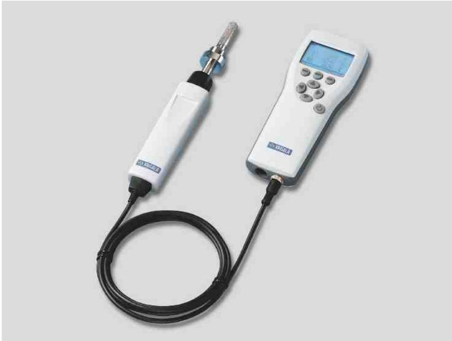
维萨拉DRYCAP®手持式露点仪DM70，为工业露点测量应用提供精确快速的测量，例如，压缩空气、金属处理、塑料干燥等。
