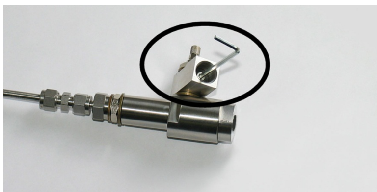
图 16 放气螺钉的拆卸
